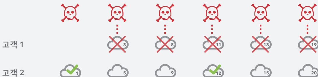
그림 3: Akamai는 네임 서버 위임을 관리하여 공격의 표적이 된 고객을 개별 클라우드 밖으로 이동시키고 공격의 표적이 아닌 고객에 대한 중복을 최소화하는 등 공격의 영향을 더욱 최소화할 수 있습니다(위의 그림 2 참조).
