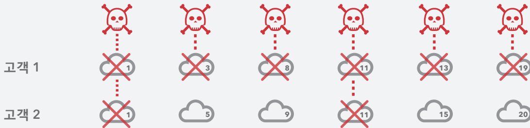
그림 2: 모든 Edge DNS 고객은 성능 및 가용성 클라우드의 고유한 조합을 기반으로 네임 서버를 수신하여 다른 고객에게 발생한 공격으로 인한 부수적인 피해를 최소화합니다.
