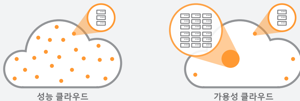
그림 1: Edge DNS는 여러 DNS 클라우드를 다양한 아키텍처와 결합하여 DDoS 공격에 대한 성능, 안정성, 가용성을 최적의 조합으로 제공합니다.
